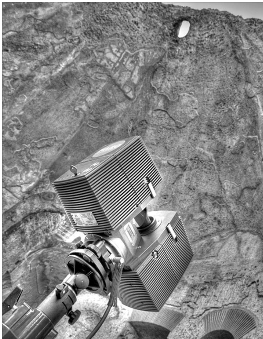
Figura 1. L'unità laserscan Faro 8080 durante le operazioni di rilievo del Serapeo nel settembre 2007.
